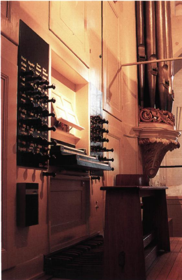
De klaviatuur van het Naber-orgel in de Sint-Joriskerk. De registerknoppen zijn verticaal, van binnen naar buiten, van het hoofdwerk, bovenwerk, rugwerk en pedaal. Achter de rug van de organist bevindt zich het rugwerk, waarvan hier een deel van het pijpwerk is te zien, met vooraan de Dulciaan en Mixtuur.
